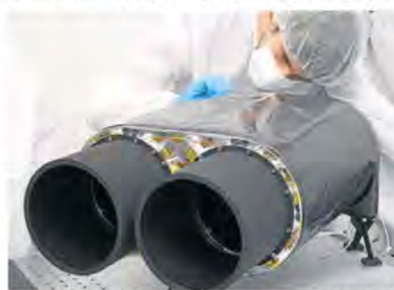
La cámara iSIM-170 será instalada en el módulo japonés de la ISS. :: E. C.
